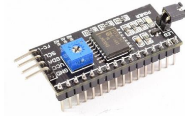
Figura 16. Controlador de lcd Módulo I2C. Fuente: https://naylampmechatronics.com/displays/60-modulo-adaptador-lcd-a-i2c.html
