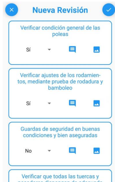
Figura 52. Parámetros de control para el bloque viajero.
