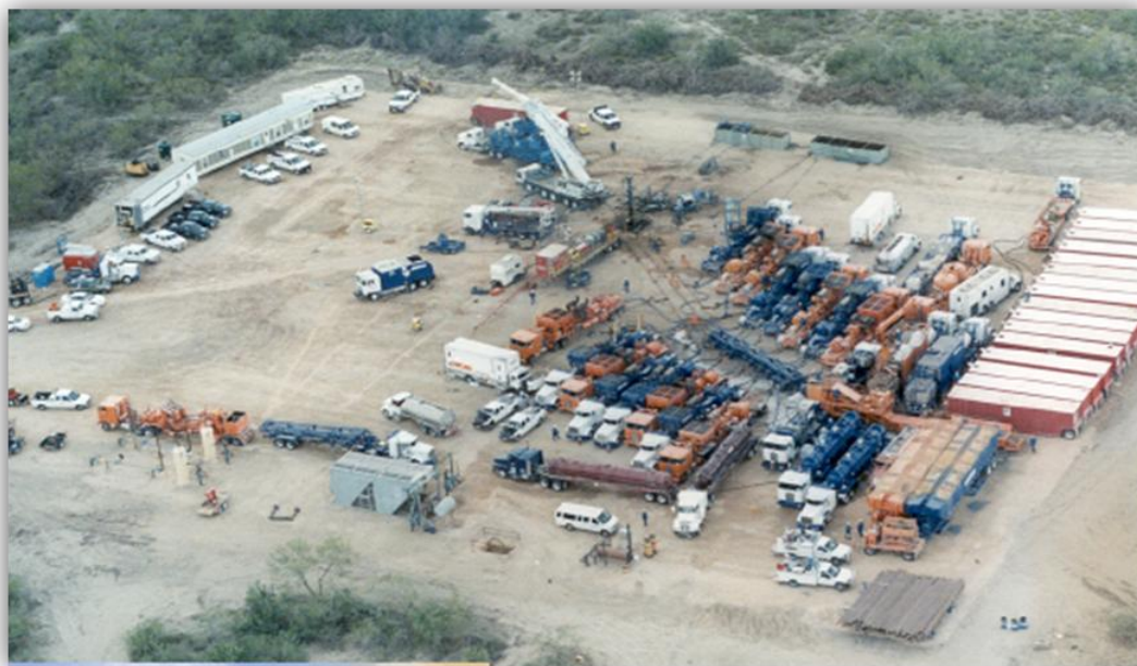
Gráfica 6. Fracturamiento Hidráulico.
