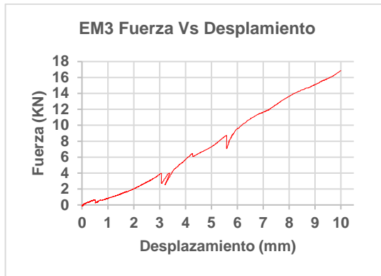
GRÁFICA 10: Detalle de relación fuerza vs desplazamiento EM3 en 10 mm.
