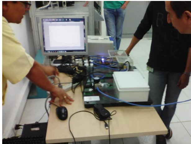
Figura 52. Vista de la nariz electrónica durante un experimento para la medida de volátiles de un compuesto comercial conocido como “silicona líquida”
