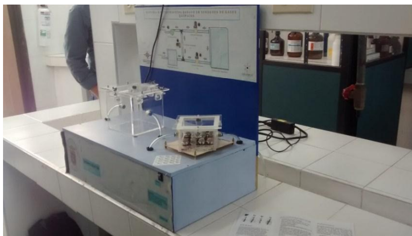
Figura 7. Equipo de Nariz Electrónica, desarrollada por la Universidad de Pamplona
