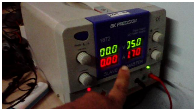
Figura 46. Vista de la fuente de poder utilizada para la alimentación de la matriz de sensores
