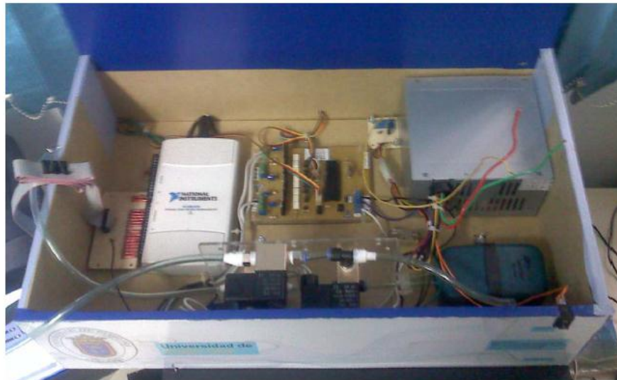
Figura 17. Equipo de nariz electrónica, vista de sus elementos en su interior
