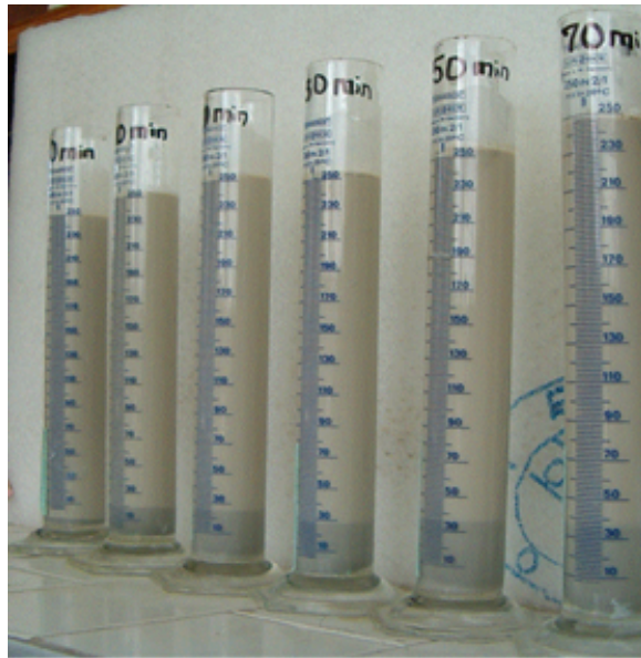
Figura C2. Probeta utilizada en el estudio de sedimentación libre
