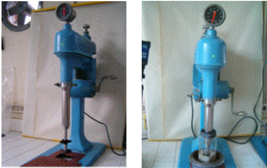
Figura C9. Etapa de acondicionamiento de la pulpa con los reactivos para la flotación.
