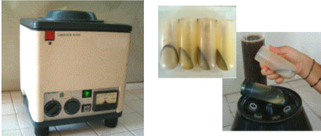
Figura C9. Etapa de acondicionamiento de la pulpa con los reactivos para la flotación.
