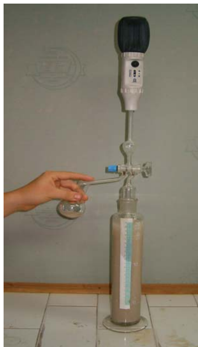
Figura B4. Fotografía y esquema de la pipeta Andreasen
