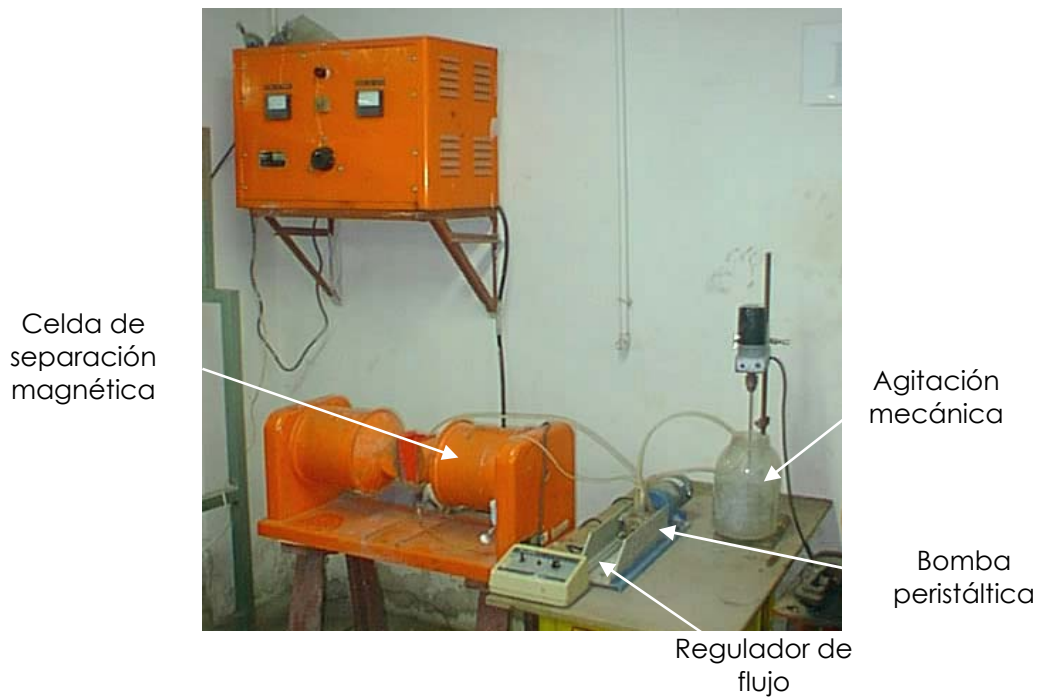
Figura C7. Esquema del sistema utilizado en separación magnética.
