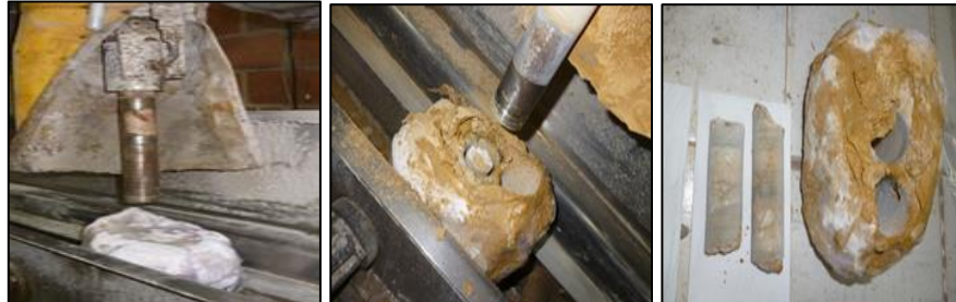
Broca hueca de acero con un cilindro guía para extraer muestras a ensayar.
