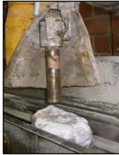
Figura 9. Extracción Manual de la Muestra de Suelo.
