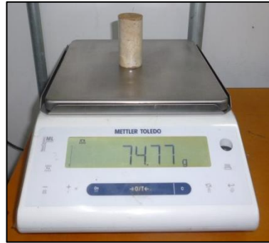
Balanza digital: Es utilizada para determinar la masa de la muestra.
