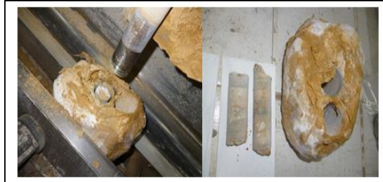
Figura 10. Extracción Manual de la Muestra de Suelo.
