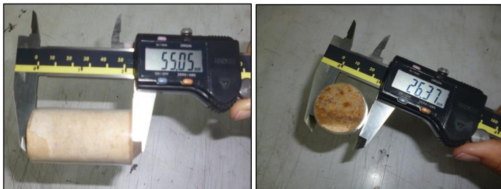
Calibrador digital: Los calibradores son utilizados para medir la longitud y diámetro de la muestra.
