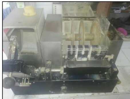
Perfiladora de superficies: este equipo es utilizado para realizar el pulimento de las caras de las muestras.
