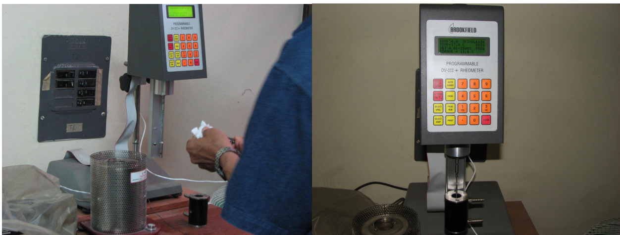
Figura 8. Viscosímetro rotacional Brookfield Rheometer DV-III+.
