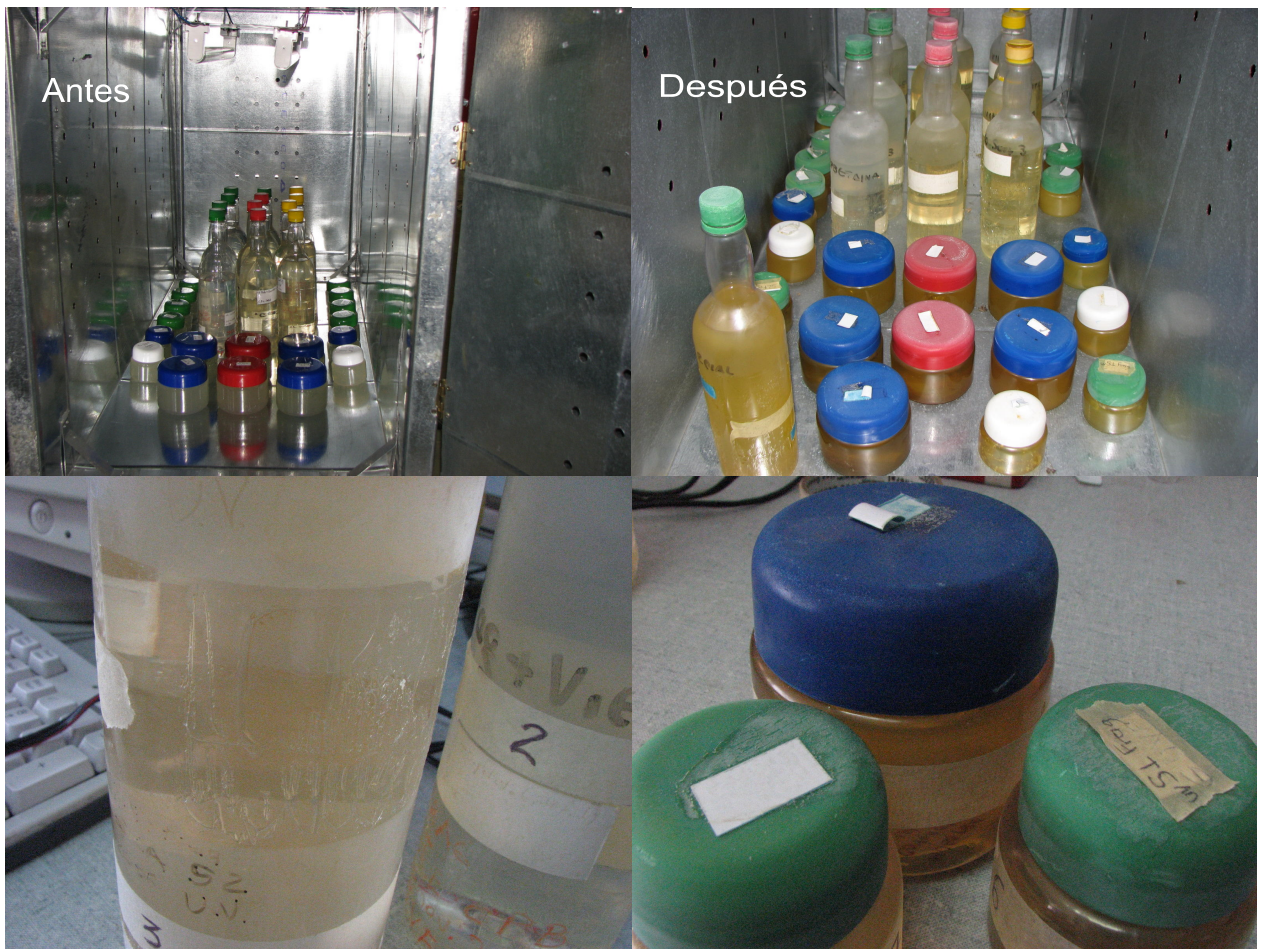
Figura 9. Efecto ocasionado en los envases expuestos a la luz ultravioleta.
