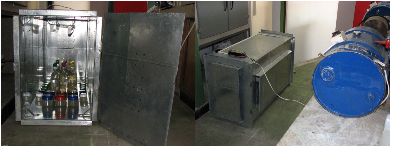
Figura 6. Cámara de emisión de luz ultravioleta.
