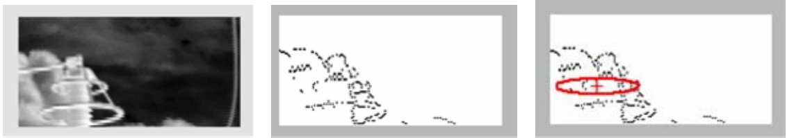
Figura 3.11 Elipse cuyos bordes no fueron detectados produciendo un error en la identificación
