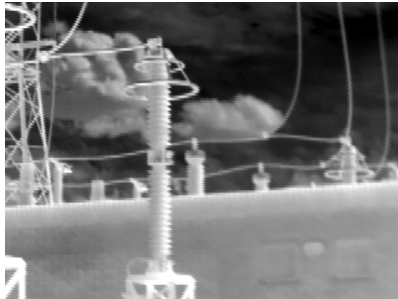
Figura B.3 Traslape con muros y nubes con poseen un mismo nivel de radiación térmica
