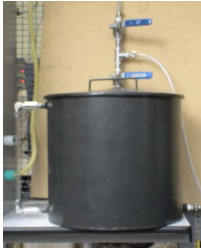
Figura C.7. Fotografía del tanque de almacenamiento de bicarbonato
