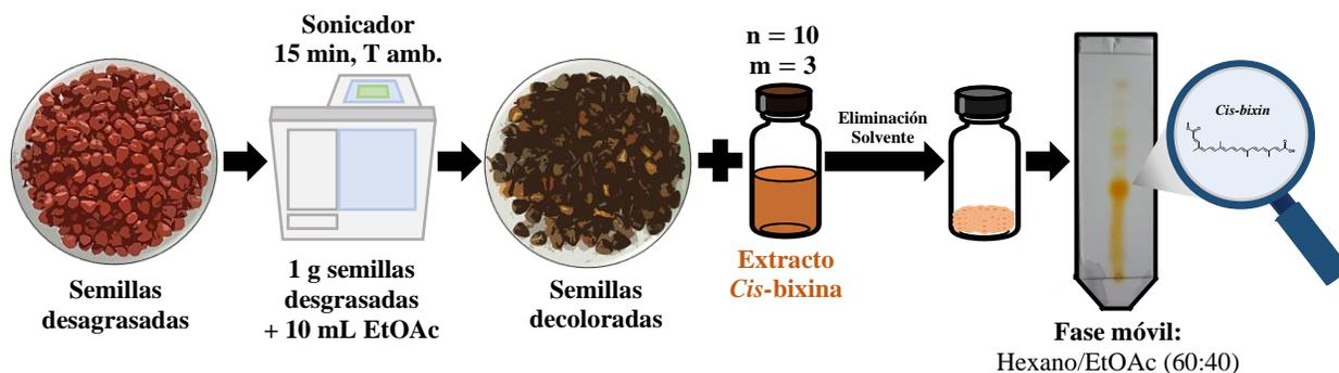
**Figura 15.** Resultados del proceso UAE con obtención de dos productos, semillas decoloradas y un extracto rico en *cis*-bixina, en donde  $n$ , corresponde al ciclo de extracción y  $m$ , al número de experimentos. Asimismo, se muestra una TLC evidenciando algunos de los compuestos extraídos.
