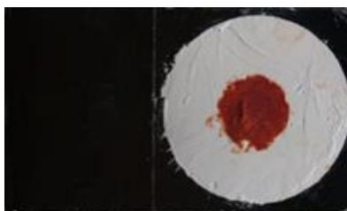
**Figura 13.** Portamuestra con 5 mg de *cis*-bixina depositada en un fondo de  $\text{BaSO}_4$  para análisis por reflectancia difusa.
