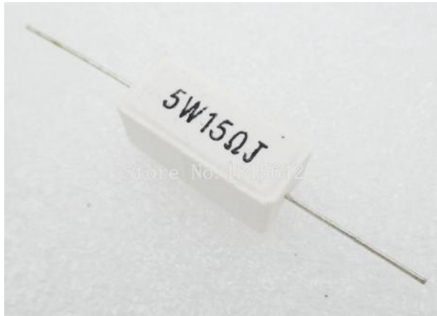
Figura 40. Resistencia cerámica 15 [ \Omega ] , 5 [W].
