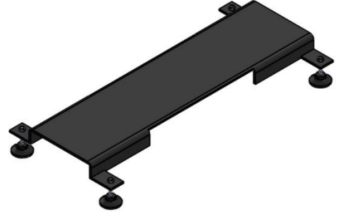
DETALLE PATA NIVELADORA ESCALA 1:1
