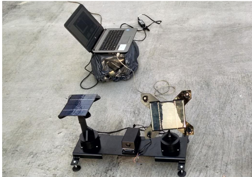
Figura 77. Ejecución del conjunto robot-seguidor durante las pruebas
