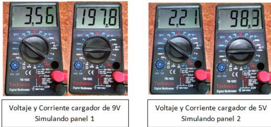
Figura 73. Lectura de voltaje y corriente por medio del multímetro.
