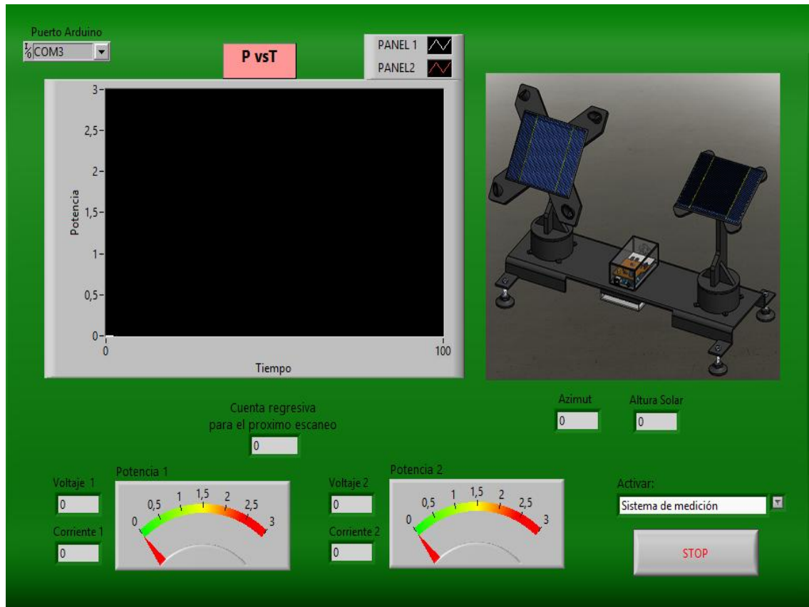
Figura 67. Interfaz gráfica en LabVIEW para extraer datos.
