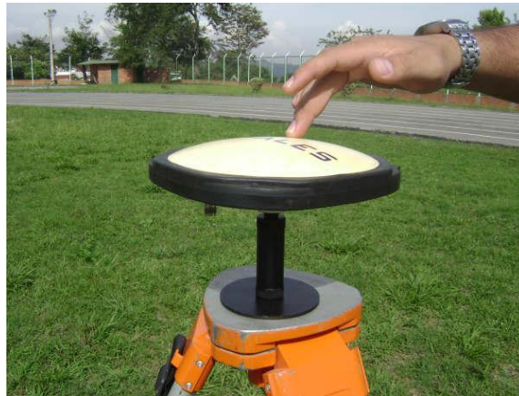
Figura 40. Instalación de la Antena
