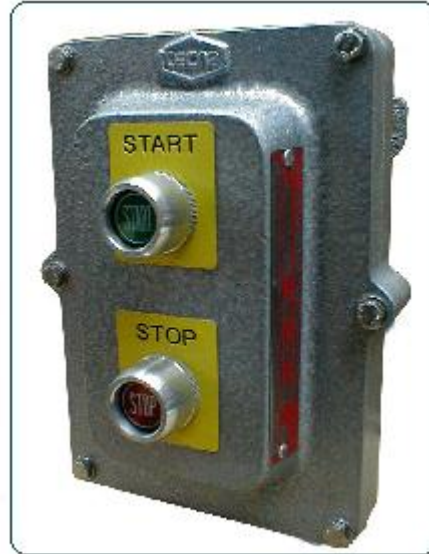
Figura 5. Pulsador de encendido o botonerías a prueba de ignición de polvos, adecuado para lugares Clase II, Grupo E, F y G, marca TECNA.
