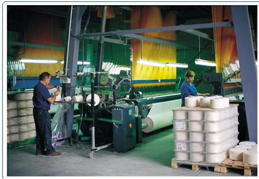
Figura 2. Ejemplo para la clasificación de los Lugares clase III, División 1: fábricas de algodón y otros textiles.
