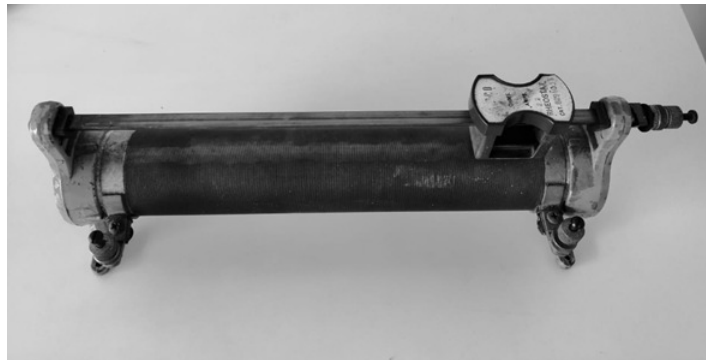
Figura 10. Reóstato utilizado como carga resistiva
