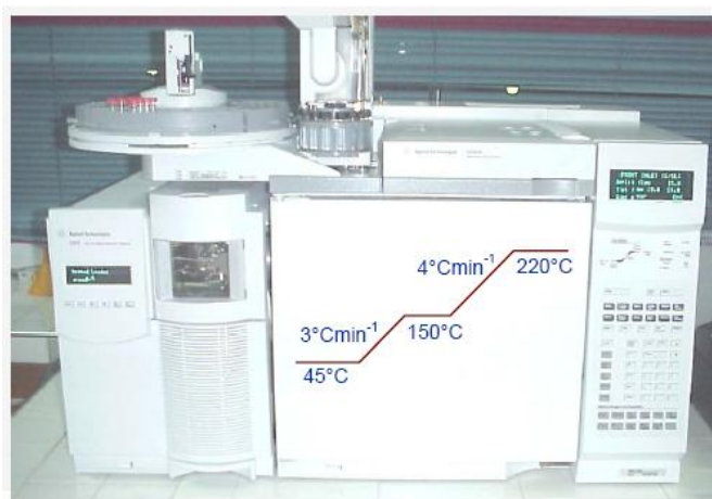
Figura 11. Cromatógrafo de gases Agilent Technologies 6890 Plus series , GC System acoplado a un detector selectivo de masas (MSD) Agilent Technologies 5973 Network y un inyector automático Agilent Technologies 7683 Series , utilizados en el presente estudio.
