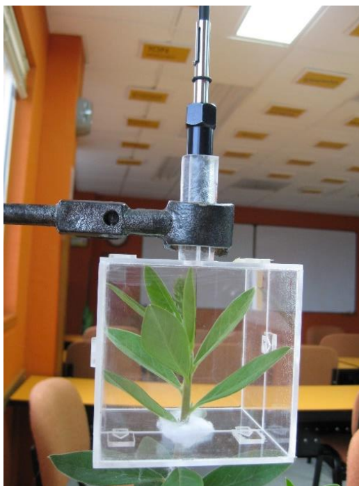
Figura 4. Montaje para la extracción de volátiles mediante el uso de HS-SPME.
