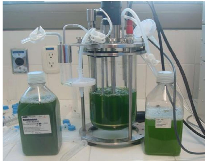
Figura 3. Fotobiorreactor con cultivo de C. vulgaris en medio Bold Basal Fuente: Laboratorio de Biomasa. Escuela de Ingeniería Química. Universidad Industrial de Santander.
