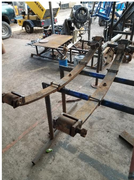
Figura 43. Ballestas listas para montaje.
