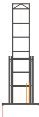
Figura 28. Vista frontal de la estructura con la ubicación de estas cargas.
