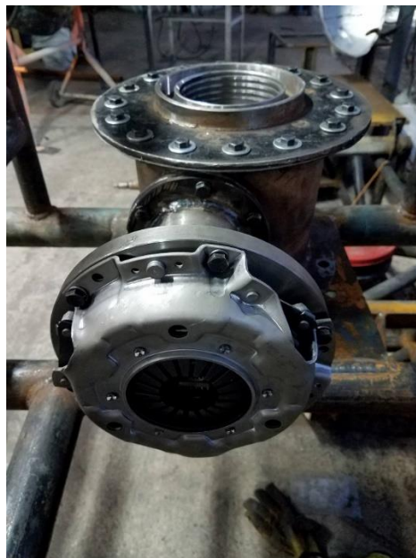
Figura 19. Mesa rotaria centrada y ensamblada a su embrague
