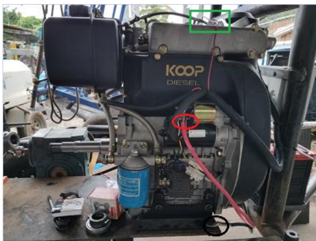
Figura 55. Motor con sus cables positivo, negativo y la conexión para la presión de la bomba de aceite.
