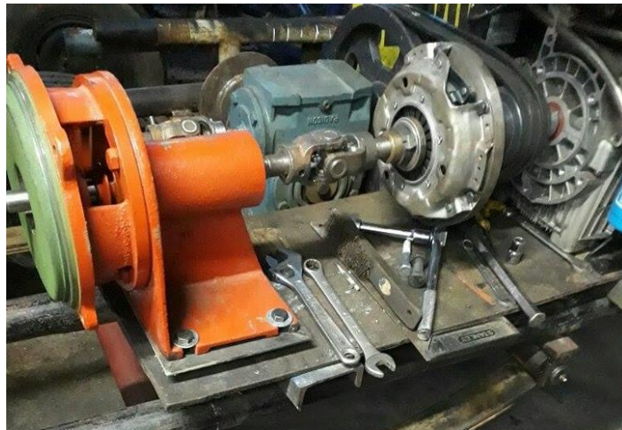
Figura 61. Montaje finalizado del motor con la bomba de lodos.
