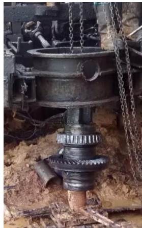
Figura 13. Mesa rotatoria en desarme
