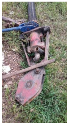
Figura 11. Imagen de la junta de perforación o Swivel, en unión con el vástago de perforación o Kelly.
