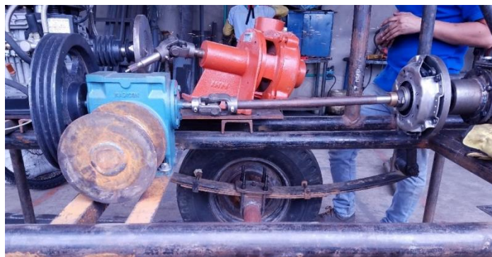
Figura 60. Ensamble general eje rotaria-embrague-reductor.
