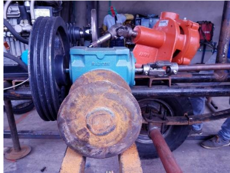
Figura 23. Polea conducida tipo A de Diámetro primitivo 8”
