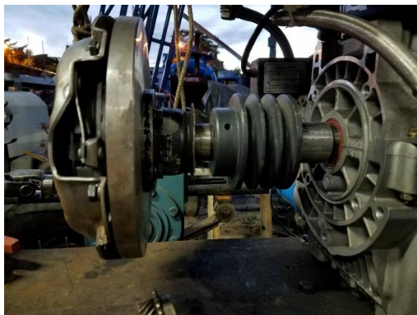
Figura 22. Polea motriz tipo A de Diámetro primitivo 4”
