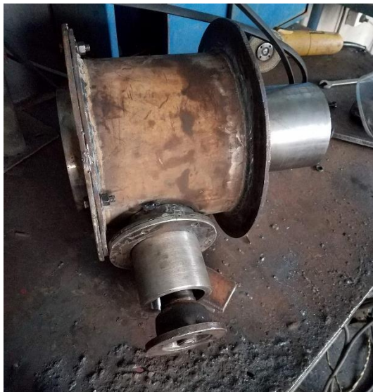
Figura 53. Mesa rotaria lista para su montaje en la estructura.
