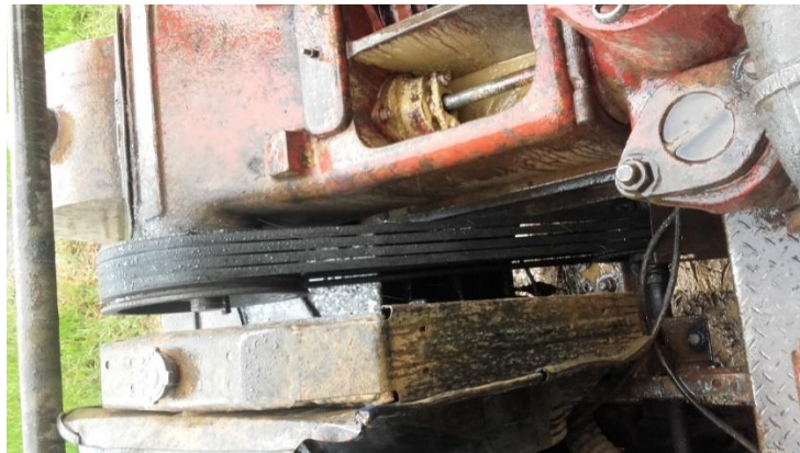
Figura 8. Transmisión por correas.
