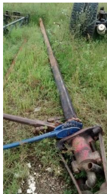
Figura 15. Vástago de perforación o Kelly, anclado con un swivel o junta de perforación.
