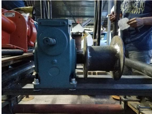
Figura 59. Conjunto reductor - malacate.
