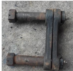
Figura 45. Ejes de articulación de resortes de hoja.
