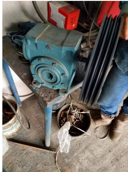
Figura. Reductor Radicon con relación 20:1
