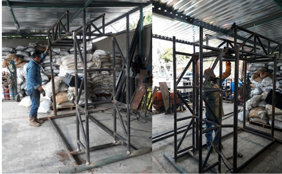
Figura 38. Ensamble torre de perforación con base estructural.
