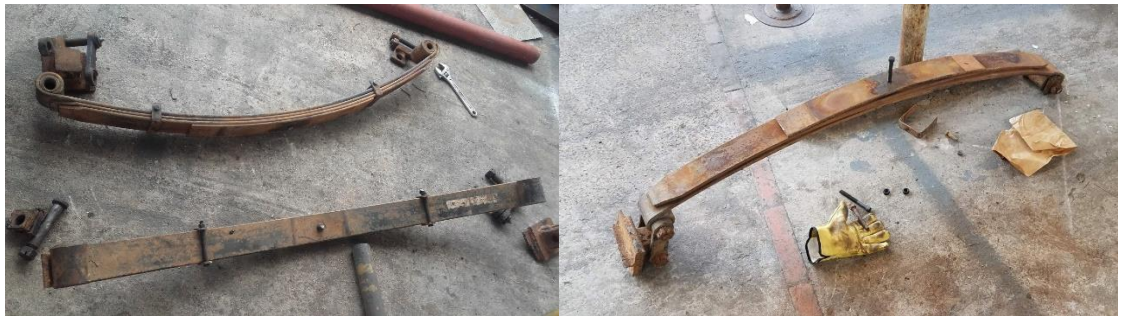
Figura 42. Resortes de hoja con uniones, centrados y fijados.
