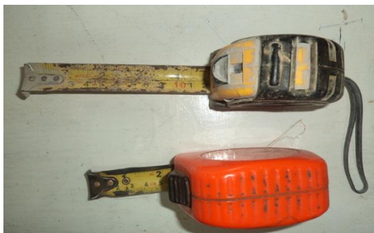
Figura 21: Flexómetros en mal estado
