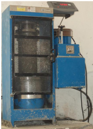
Figura 11: Ensayo a compresión
