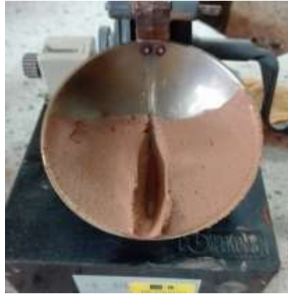
Figura 5. Ensayo de límite líquido
