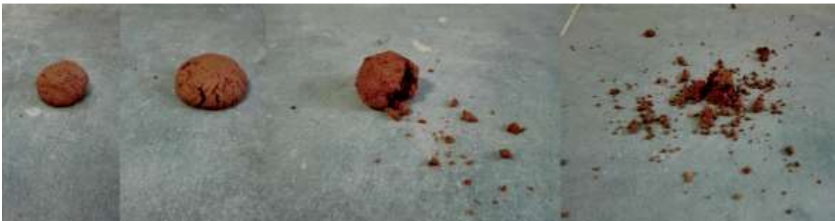
Figura 2. Ensayo de caída de bola a suelos variados
