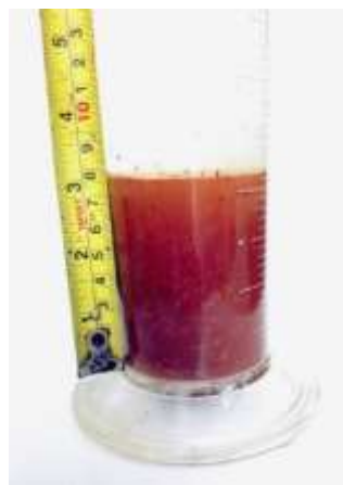
Figura 1. Ensayo de sedimentación a muestra de laboratorio
