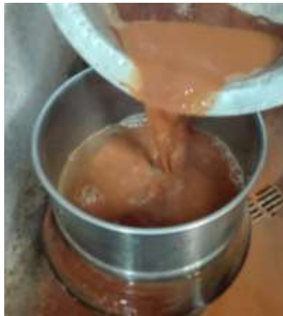
Figura 3. Proceso de lavado de la muestra por tamiz 200
