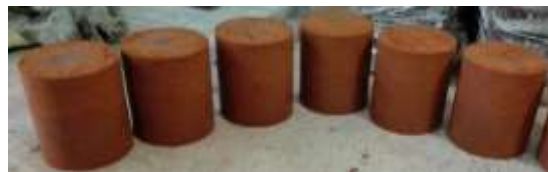
Figura 8. Cilindros en estado fresco para ensayo de resistencia a la compresión en días 7,14 y 21
