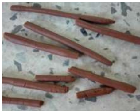
Figura 4. Ensayo de límite plástico
