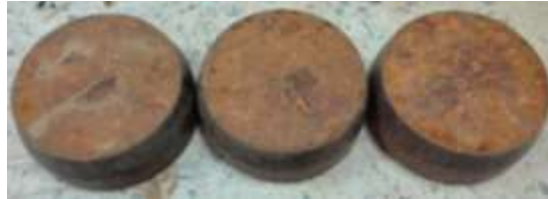
Figura 7: Anillos de corte de suelo con material para prueba de corte directo
