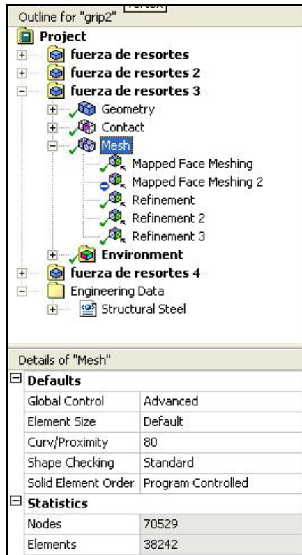
Figura 64. Mesh de la Pinza -Escenario 1
