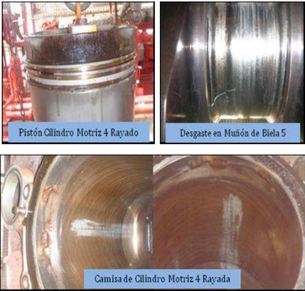
Figura 13. Imágenes de la fallas
