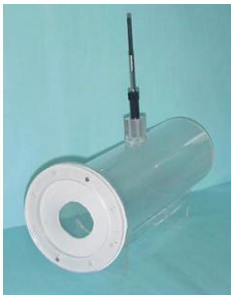
Figura 26. Dispositivo sin corriente de aire, empleado para el estudio del comportamiento del perfume, aplicado sobre la piel del antebrazo.
