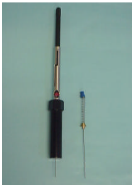
Figura 17. Dispositivo empleado para la microextracción en fase sólida (SPME).
