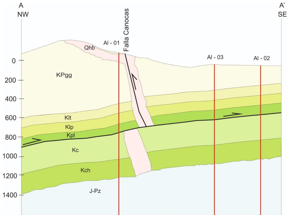
Figura 4. Corte geológico A-A' (Localizado en la Figura 2C). Las líneas rojas localizan los puntos adquiridos con el método magnetoteléurico en campo. Unidad Cuaternaria Qhb, Cretácicas KPgg, Klt, Klp, Kpl, Kc, Kch y Jurásicas J-Pz, cuya equivalencia aparece en la Figura 3.
