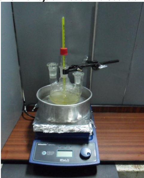
Figura 13. Montaje utilizado en la Cocrystalización
