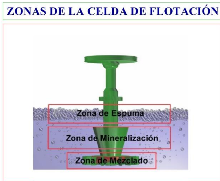
Figura 2. Zona de movimiento celda de Flotación
