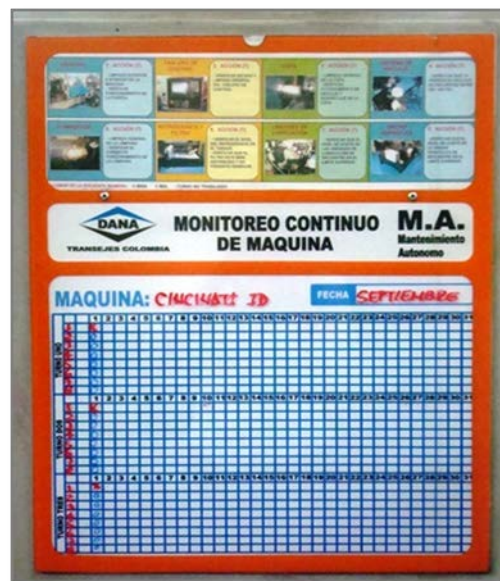
Ilustración 23. Tablero de Inspección TPM
