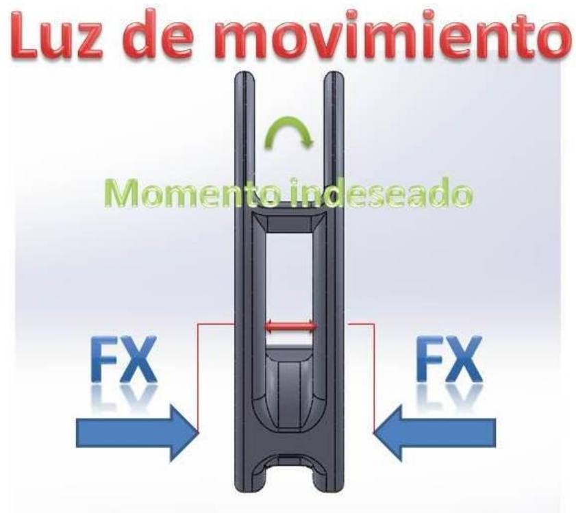
Figura 78 Transmisión de fuerzas en X
