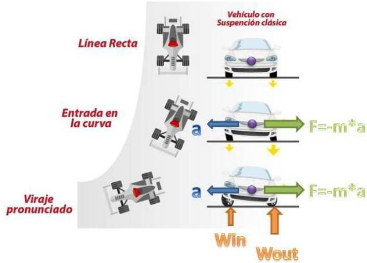
Figura 32 Transferencia de masa lateral
