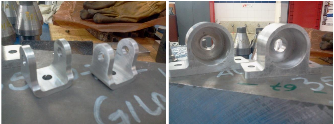
Figura 136 Anclajes de las barras push y bases de soporte
