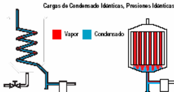
Figura 14-3. Serpentín continuo, presión constante en flujo por gravedad a la trampa. 300 kg/hr de condensado de un serpentín de bronce a 3 bar. Drenaje por gravedad a la trampa. Volumen muy bajo del vapor. Factor de Seguridad de 2.
