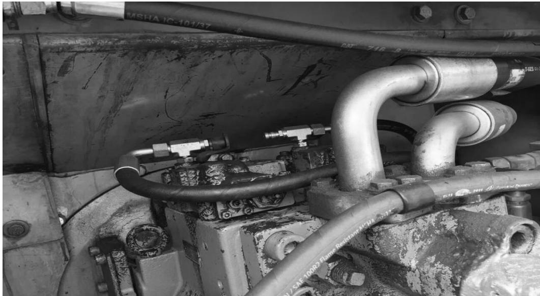
Figura 20. Fugas Hidráulicas en Campo Retroexcavadora
