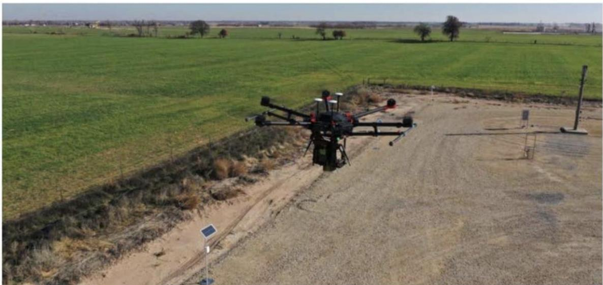
**Figura 20** Vista general del sobrevuelo de un dron para la detección de gas metano. (Saadawi, 2020)
