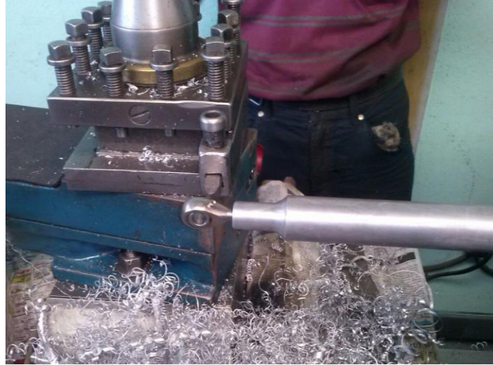
Figura 38. Mecanizado del sistema del pilón
