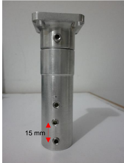
Figura 48. Modificación del sistema de altura
