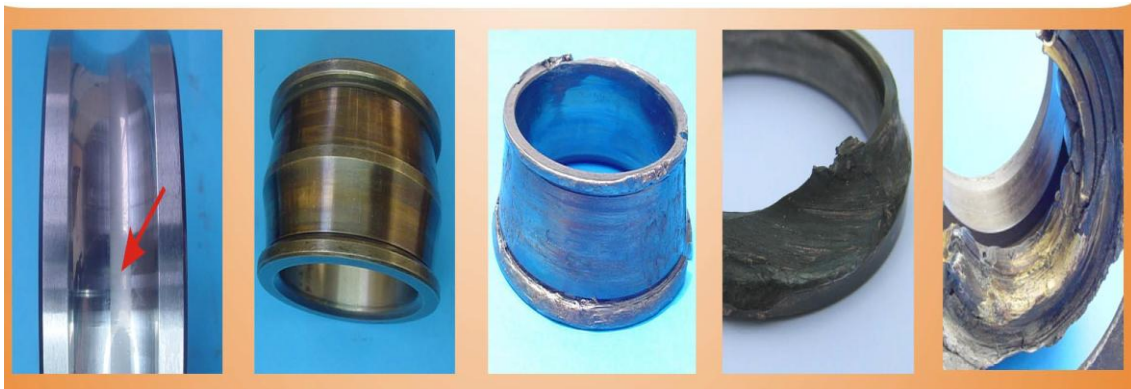
Figura 9. Ejemplo de desgaste adhesivo en rodamiento.
