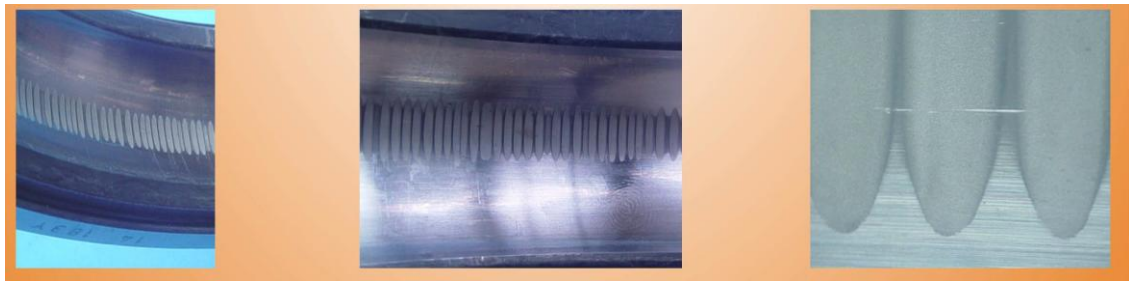
Figura 10. Ejemplo de estrías por corriente eléctrica.
