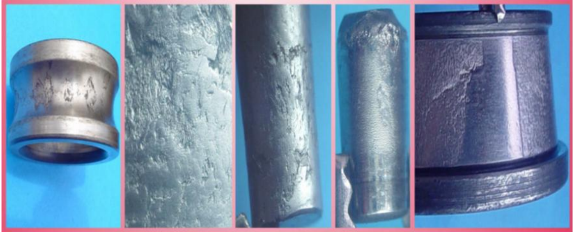
Figura 2. Ejemplo de agrietamiento en la superficie con pérdida de material poco profundo micropicado (descamación)
