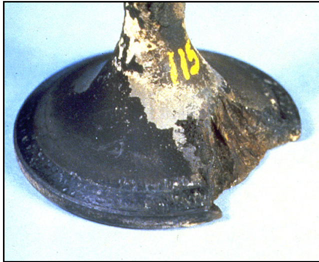
Figura 6. Daño en válvula por pre-ignición
