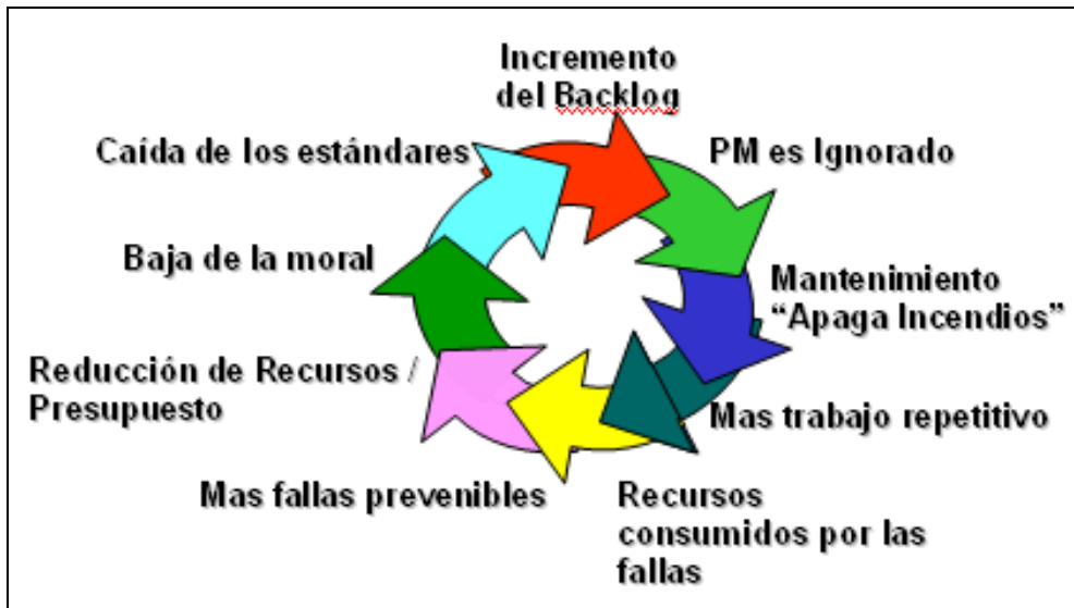
Figura 12. Circulo vicioso del mantenimiento
