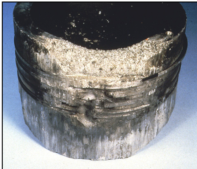
Figura 5. Daño en pistón por consecuencia de detonación
