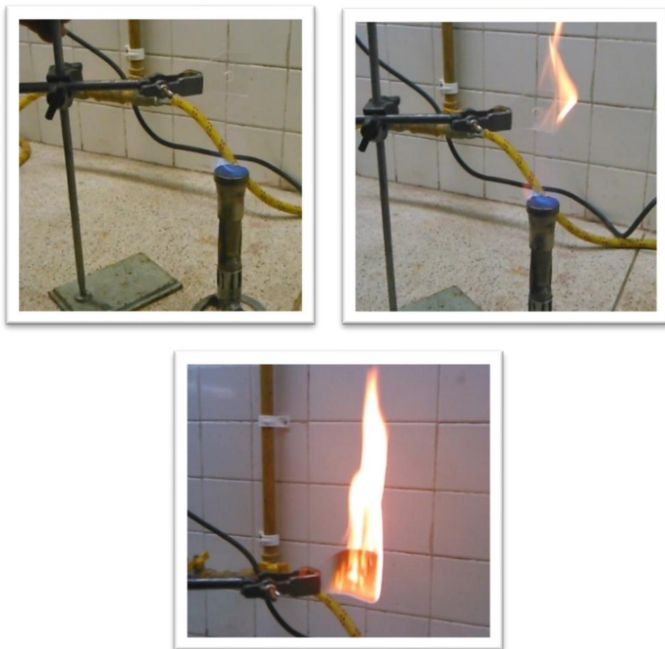
Figura 6. Prueba de llama del residuo polimérico.
