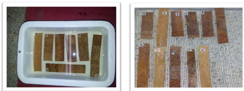
Figura 11. Prueba de humedad e hinchamiento
