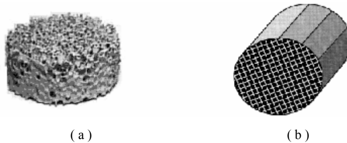
Figura 1. (a) Monolito tipo esponja, (b) monolito tipo canales rectos y paralelos.
