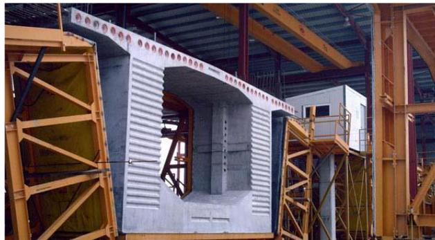
*Figura 31. Dovela en parque de prefabricación*
