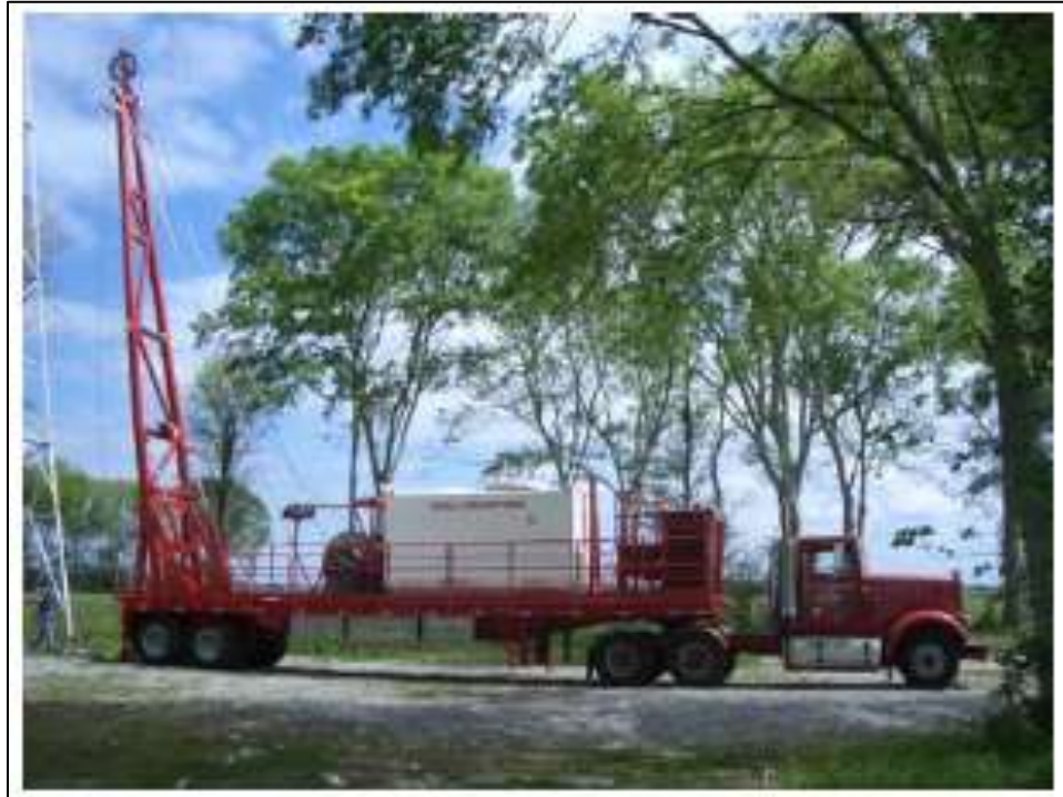
Figura 25: “Frac Trailer” y sistema de monitoreo de fracturamiento
