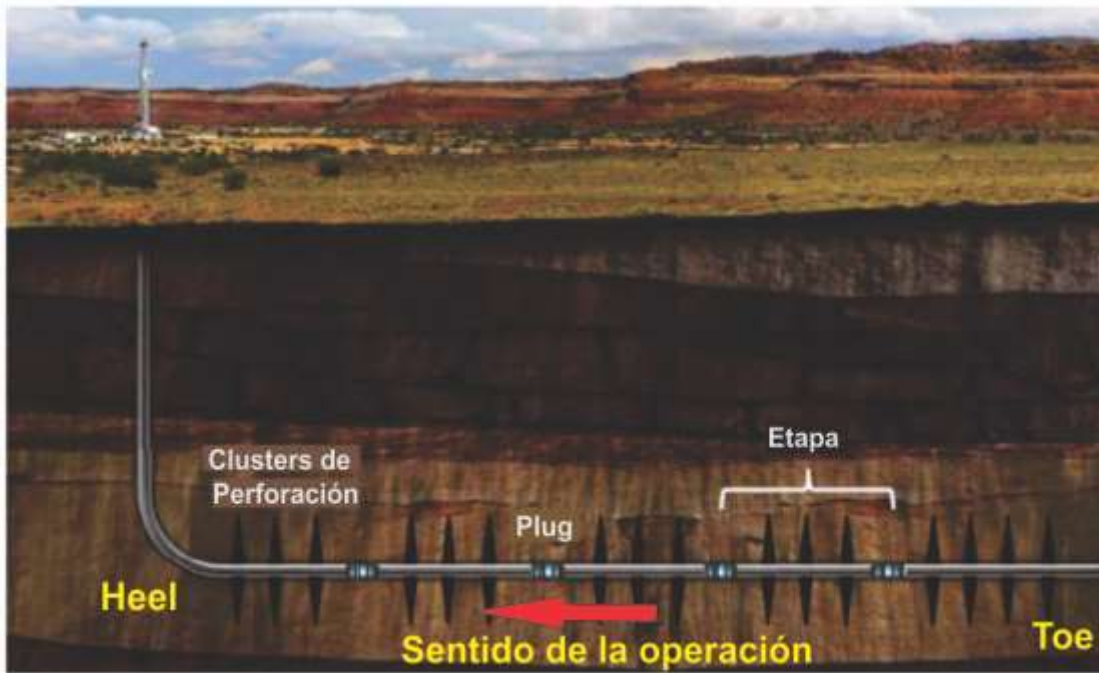
Figura 5: Ilustración de un sistema Plug-and-perf
