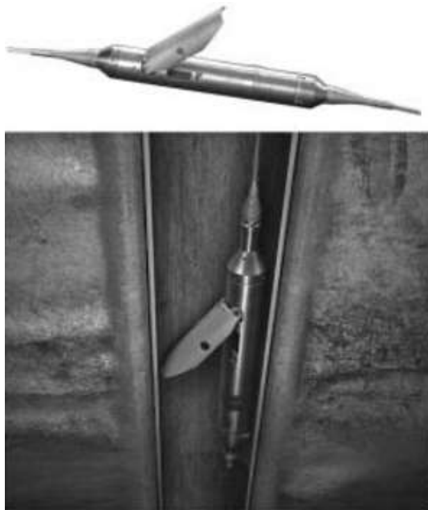
Figura 27: Sensor 3C Wireline, con brazo de fijación para sujetarse en el pozo.
