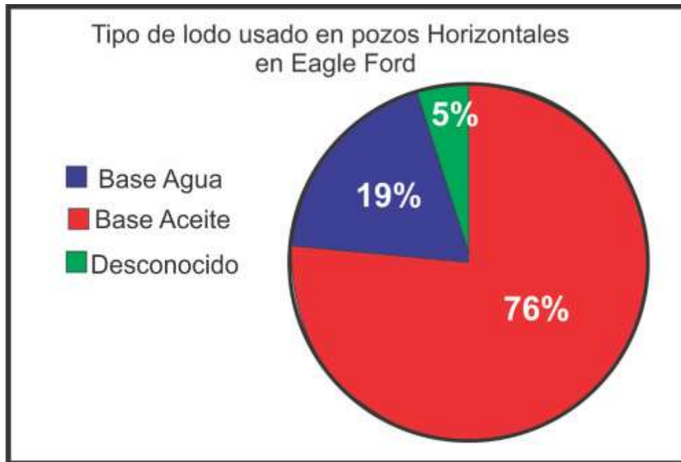
Figura 48: Distribución de fluidos de perforación para las secciones curva y lateral en el shale play Eagle Ford de EUA.
