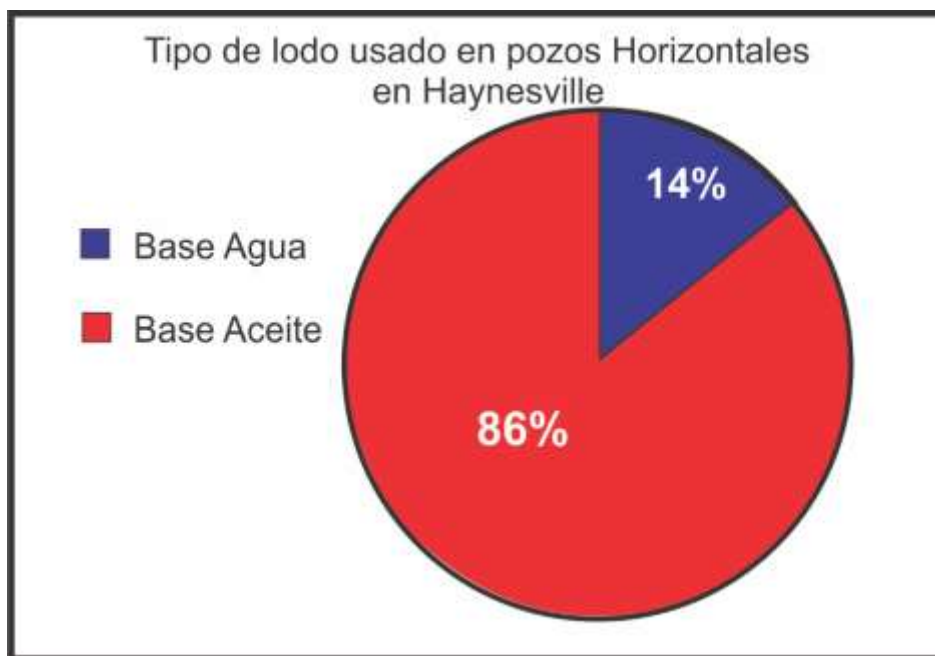
Figura 54: Distribución de los fluidos de perforación en la secciones curva y lateral del shale plays Haynesville en EUA.
