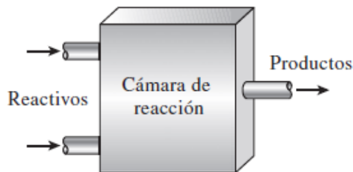
Figura 2. Proceso de combustión de flujo estacionario
