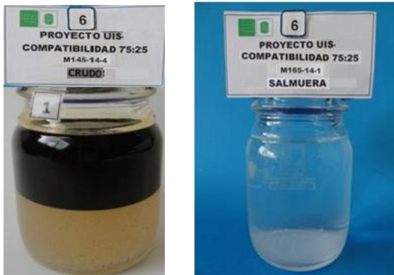
Figura 10. Prueba de compatibilidad de Ácido gastado M145-14-4 y M165-14-1, en una proporción de 75:25
