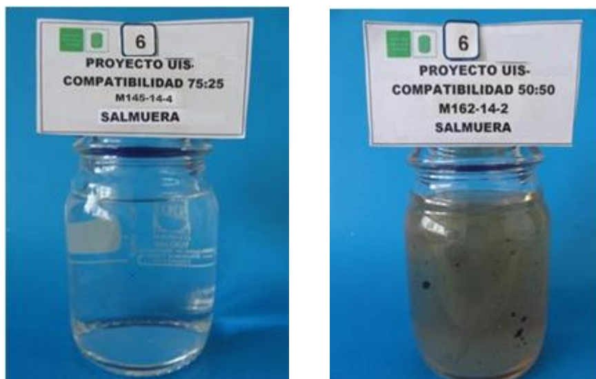
Figura 9. Apariencia de los disolventes evaluados después de las 24 horas. Disolvente M145-14-4 y M162-14-2 en la proporción 75:25 y 50:50 respectivamente.
