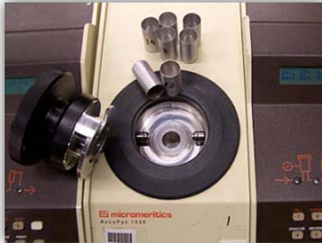
Figura - 433 - Picnómetro de Baja Presión (LPP), y celdas de aluminio para las muestras.
