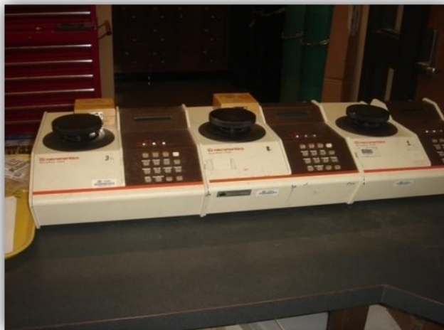
Figura - 28 - LPP (Picnómetro de Baja Presión) usado en la medición de Porosidad Total o Porosidad de Helio.
