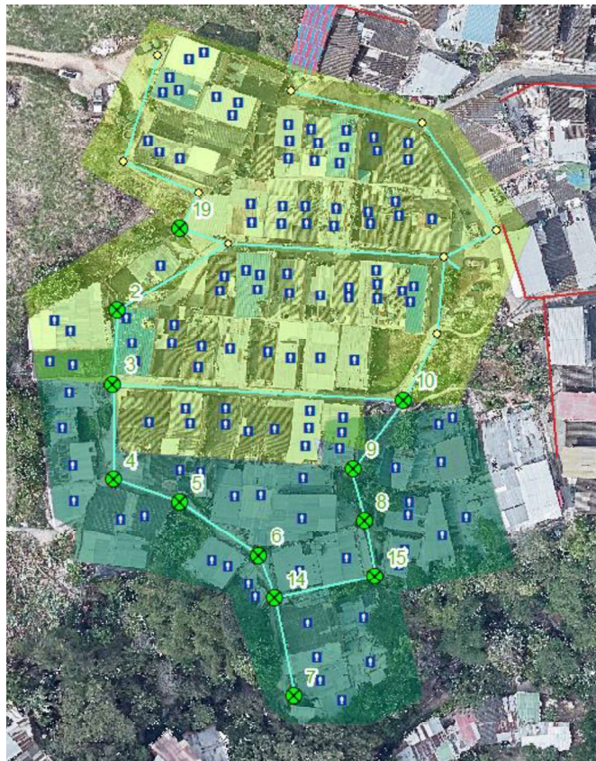
Figura 11. Sectorización de presiones en la red Villa del Carmen.
