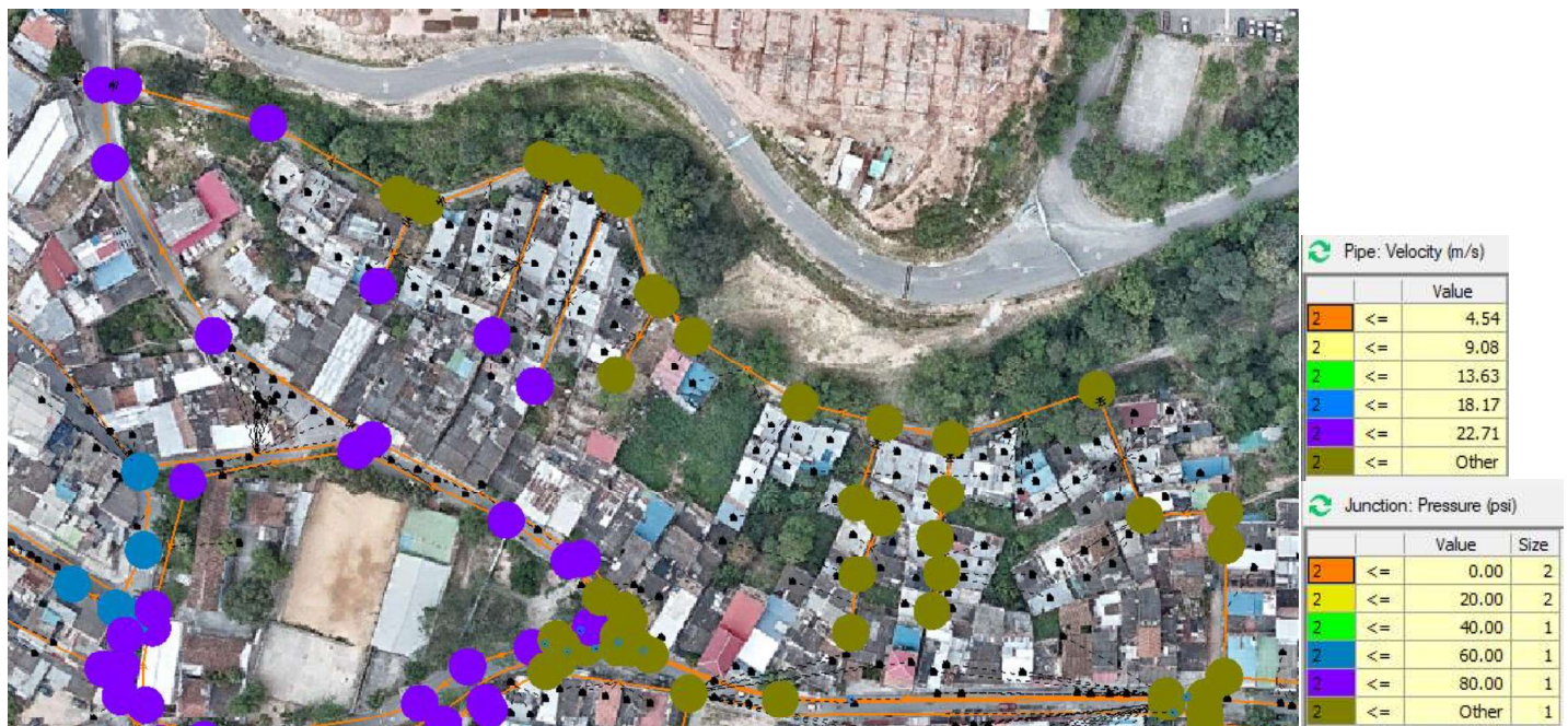
Figura 9. Mapa de presiones del modelo Pila Bellavista Campestre.
