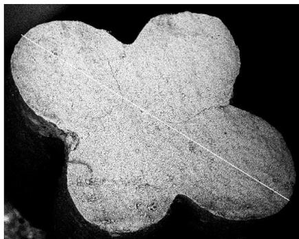
**Figura 18.** Micrografía 100X de la sección transversal del pellet del catalizador B3-90. Se indica el recorrido del mapeo de línea.
