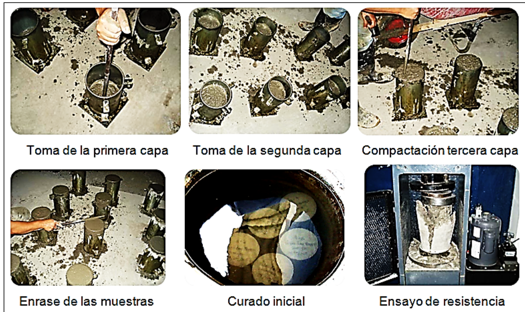
Figura 37 Toma de cilindros para laboratorio.
