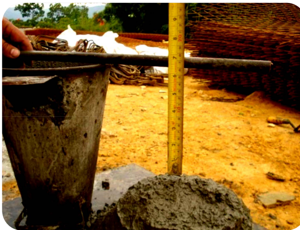
Figura 36 Prueba de Asentamiento del Concreto
