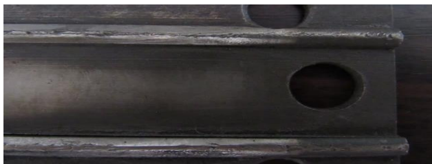
Figura 10. Detalle del desgaste de la parte superior de la matriz.
