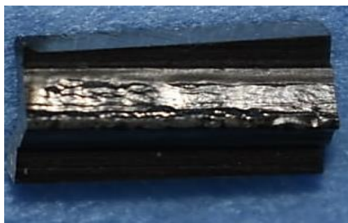
Figura 3. Probeta de muestra que sufrió desgaste de la matriz de acero de herramientas AISI H13
