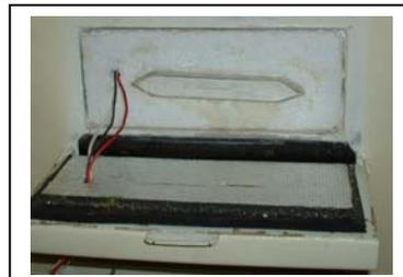
**Figura 3.13. Aislante de icopor en las tapas.**
