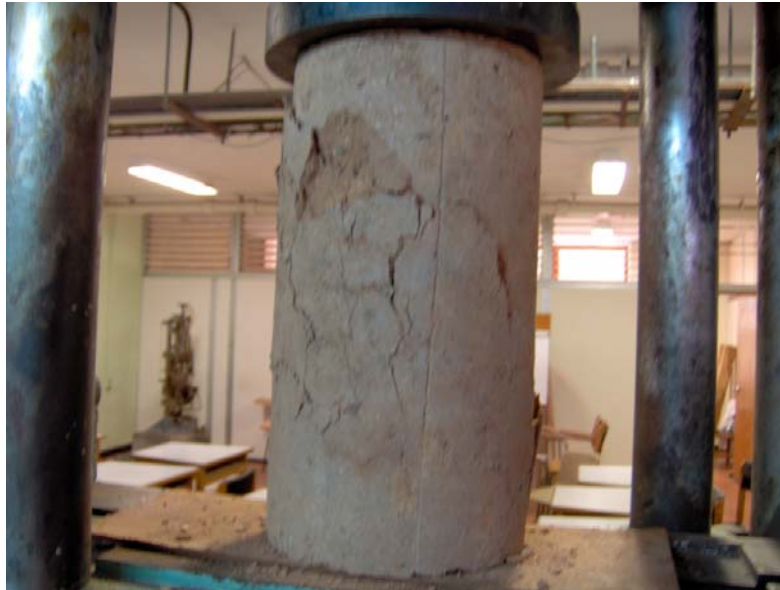
Figura 4. Probeta Grande sin adición de Nylon fallada a Compresión Simple.
