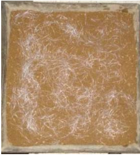
Figura 20. Mezcla del suelo con el Nylon, Probeta Grande antes de fallar y Probeta fallada.
