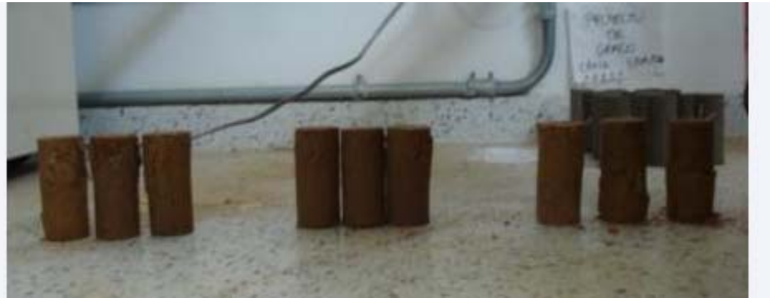
Figura 7. Probetas Harvard Miniatura reforzadas con Nylon después de fallar.
