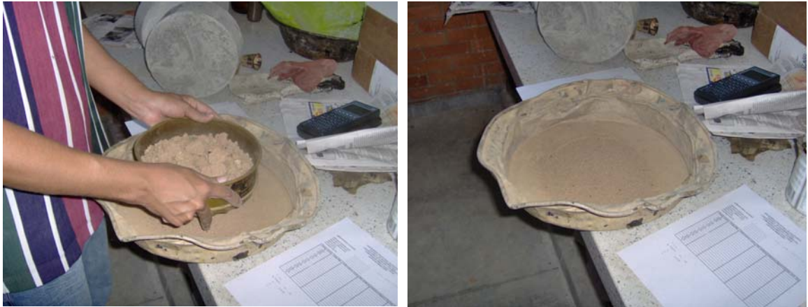
Figura 21. Tamizado de suelo por el Tamiz N° 4, para realizar las Probetas.
