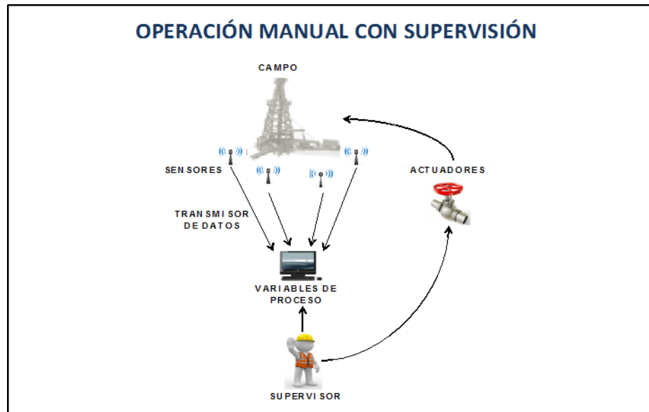
Figura 4. Operación manual con supervisión
