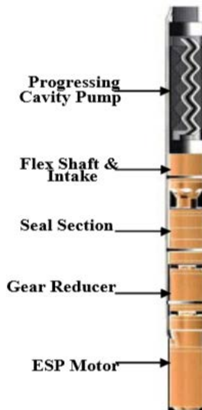
Grafica 32. Unidad de Bombeo Electro-PCP.
